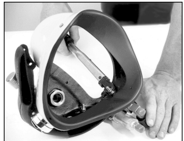
Fig. 6.26 Remove the stud nut.
